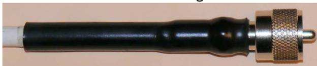
Im Außenbereich werden die Schraubverbindungen mit mindestens 8cm Schrumpfschlauch mit Klebstoff aus der E-Branche (z.B. Cellpack) eingeschrumpft.
