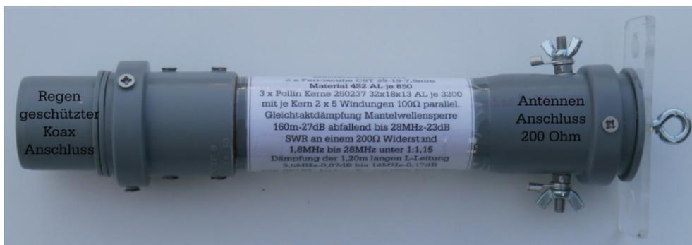
Die fertige Balunkombination in einem HT-Gehäuse Gehäuse Länge über alles 28,5 cm / Gewicht 387 Gramm / D ≈ 40mm /
