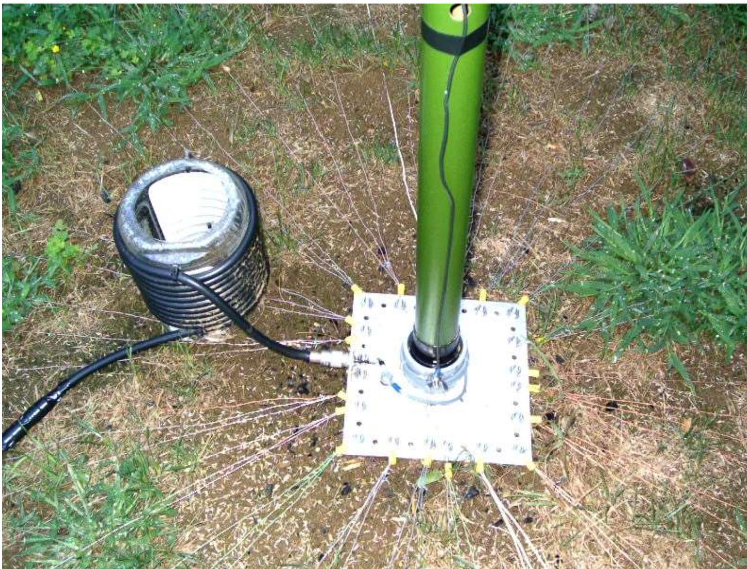
Luftbalun für eine 40M Vertikale (Einbandversion) 3,5m RG213
