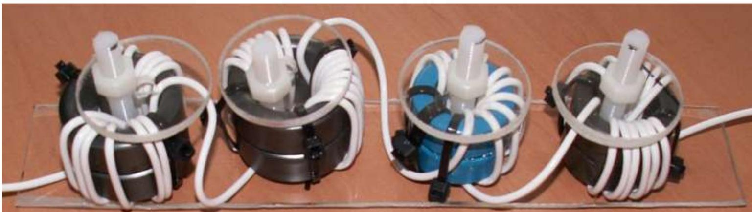
Dämpfung breitbandig um die 60dB / kleine Kerne für RG188 / Leistung 200W
