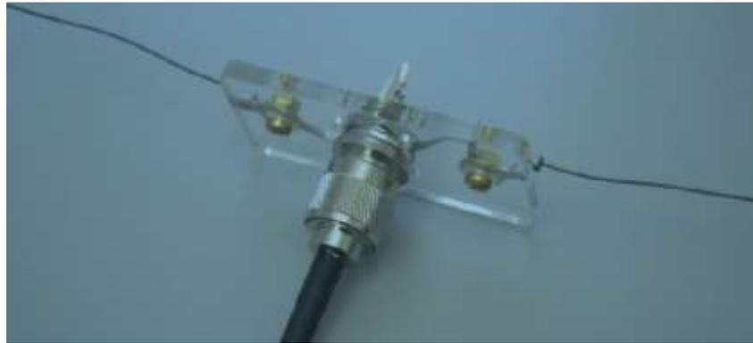
Speisung eines Dipols oder einer Delta-Loop ohne Balun
