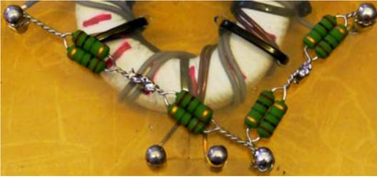
Da der Balun als Trennglied arbeitet, liegt die ganze Antennenanlage hoch und hat keine Verbindung mit einer Erde. Dies hat Prasselstörungen beim Empfang und manchmal Überschläge im Kondensator zur Folge. 1M $\Omega$ /8W Widerstände zwischen Massepotential und dem Kondensator- oder Spulenanschluss verhindern dies hier zuverlässig. **Achtung! Kein Blitzschutz!**
