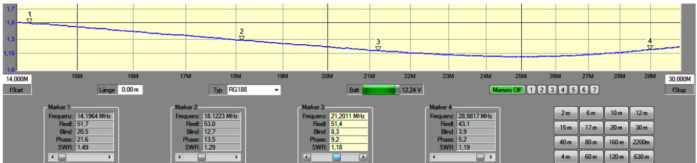
Stehwellenverhältnis als Funktion der Frequenz 14MHz-30MHz T130-6 an 470Ω
