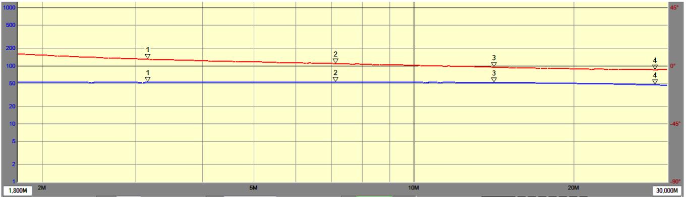
Scheinwiderstand & Phasenwinkel als Funktion der Frequenz 1,8MHz-30MHz
