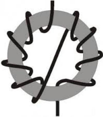
Wird für die Zuleitung Koax RG58 verwendet, lässt sich dieses ohne jedes Gehäuse mit 5+1+5 Wdg. auf einen Ferritkern wickeln.
