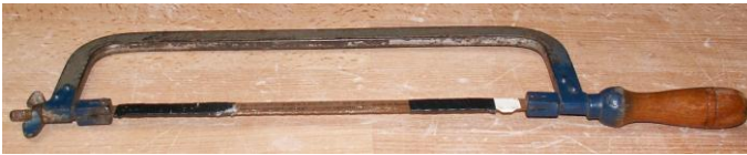
Metall-Bügelsäge, zweites Sägeblatt gekürzt und mit Isolierband befestigt.
