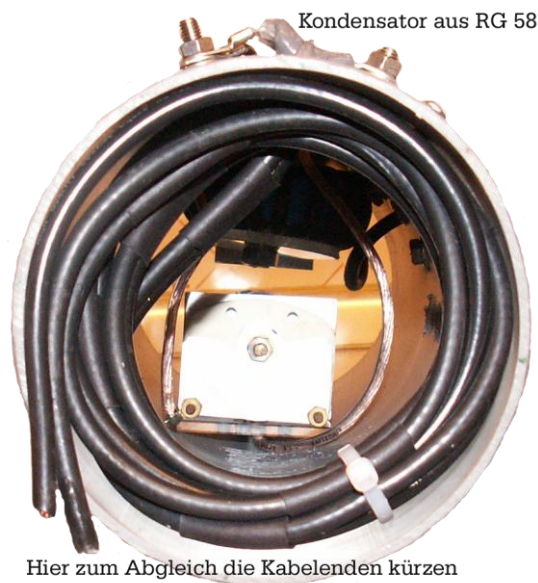
Kondensator ca. 200pF aus Koaxkabel RG58 Untergebracht oberhalb der Spule bzw. innerhalb der roten Befestigungskappe. Zum Abgleich müssen hier die beiden Kabel gekürzt werden.
