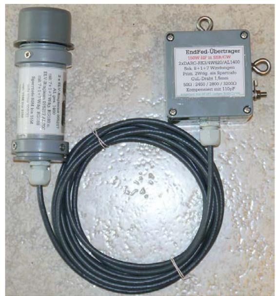
Der fertig aufgebaute Übertrager mit Koax-Gegengewicht und Mantelwellensperre
