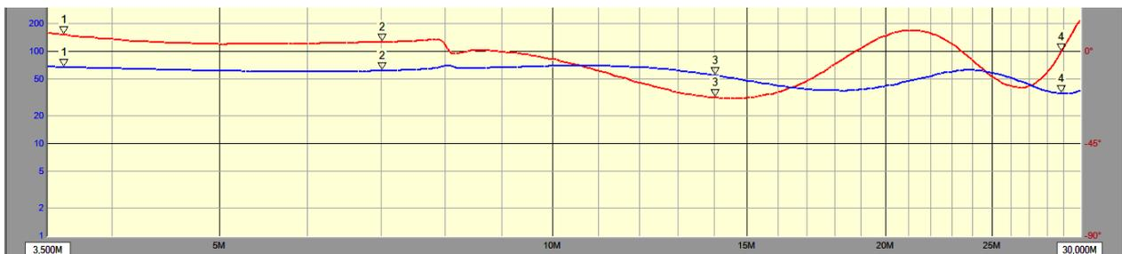
Scheinwiderstand und Phasenwinkel von 3,5MHz bis 30MHz
