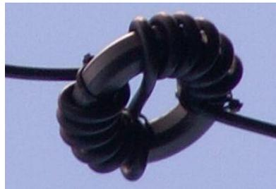
dieses nicht möglich sein, so bieten sich Ferrithülsen an, die über das Koaxkabel geschoben werden. (siehe DX-Wire, Amidon usw.) Da durch das Aufschieben pro Hülse nur eine Windung zum Tragen kommt, müssen oft viele Hülsen aufgebracht werden um eine ausreichende Spertiefe zu erreichen. Die Kosten liegen deshalb,
