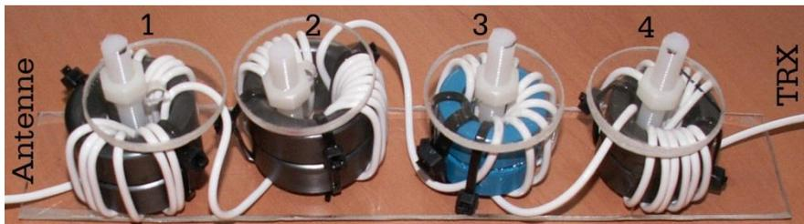
Kern1 DARC 2xRK3 mit 5+1+5 Windungen Teflon RG188 (AL 1400)
