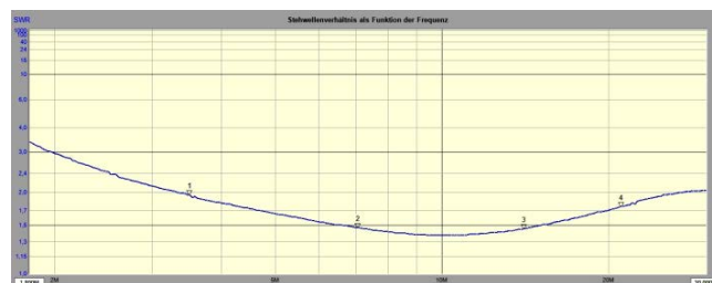
SWR 1,8-30MHz an 3,3K \Omega mit 100pF
