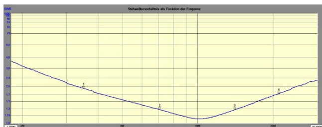
SWR 1,8-30MHz an 4,7K \Omega mit 100pF
