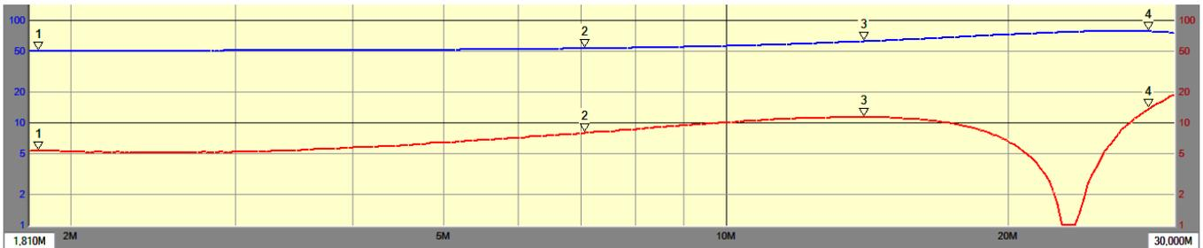
Wirk- & Blindwiderstand als Funktion der Frequenz (FA-VA3 DL1SNG)
